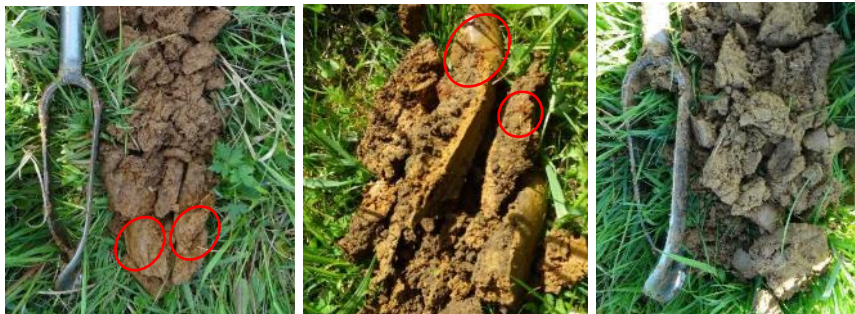
Traits rédoxiques légers (à gauche), Traits rédoxiques marqués (au milieu), Traits réductiques marqués (à droite)
