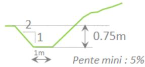
Il est ici préconisé de rouvrir le cours d'eau jusqu'en amont des services techniques. Le busage du fossé depuis la sortie du parc par un  $\phi 800$  est chiffré en variante.
