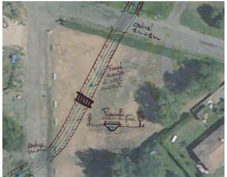
D'autre part, le fossé longeant le chemin agricole doit être déplacé en fond de thalweg sur la parcelle n°194 et le long de la parcelle n°193 afin faciliter son écoulement sous la route départementale. Le franchissement de la RD118 est augmenté avec deux buses  $\phi$ 600 (actuellement une buse  $\phi$ 300).
